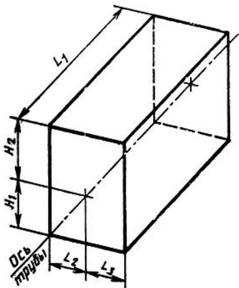
$H_1 + H_2$ ;  $L_1$ ;  $L_2 + L_3$  - соответственно высота, длина и ширина параллелепипеда, в который должен вписываться счетчик (крышка находится под прямым углом к ее закрытому положению);
